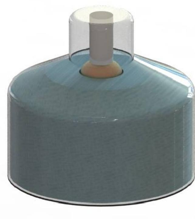
Dos WCD de la red LAGO: Izquierda, Nahuelito en Bariloche, Argentina. Centro, Characatito en Arequipa, Perú. Derecha, esquema del detector, la luz Cherenkov producida partículas secundarias de las EAS (Extensive Air Showers) en el volumen de agua pura del detector es medida por un PMT (Photomultiplier Tube) de 9" ubicado en la parte superior central.
